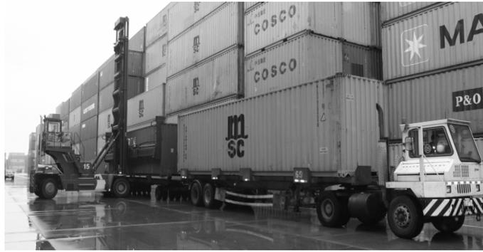
图3 “一拖多挂”模型与空箱堆高机的作业配合
