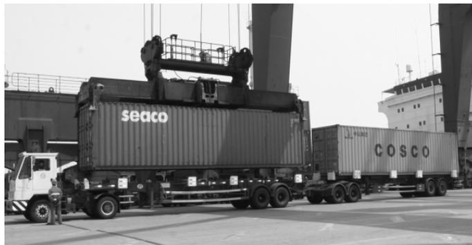
图1 “一拖多挂”模型与桥吊的作业配合
