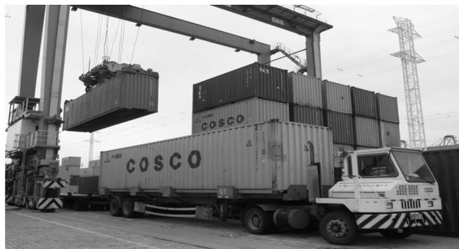
图2 “一拖多挂”模型与轮胎吊的作业配合
